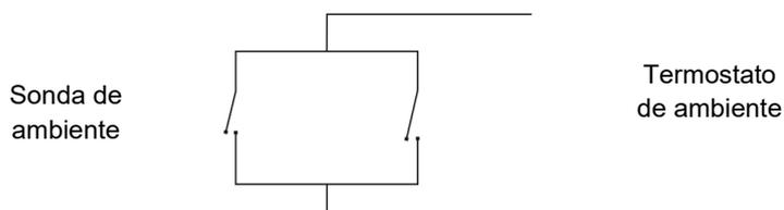
Para hacer funcionar exclusivamente el termostato externo, ajuste la temperatura ambiente al mínimo (7°C). En este punto, la estufa estará controlada exclusivamente por el termostato externo.
