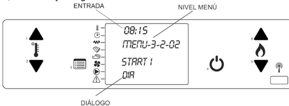
Una vez que actives el primer parámetro (M-3-2-01) "CRONO DIA", se pueden establecer dos encendidos y dos apagados. Para cada parámetro se puede seleccionar el valor "off" si no se desea activar o, en cambio, el horario de encendido y de apagado.
